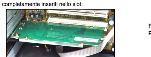
5 Fissare l'adattatore allo chassis con una vite.
