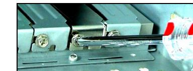
6 Kontrollera att antennen är fastskruvad på M-302. Rikta antennen uppåt.
